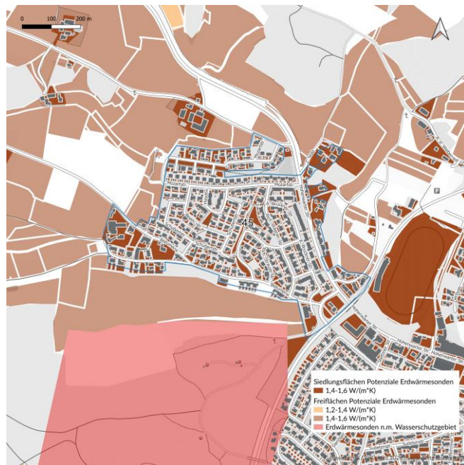
Nutzung von oberflächennaher Geothermie durch Erdwärmesonden
