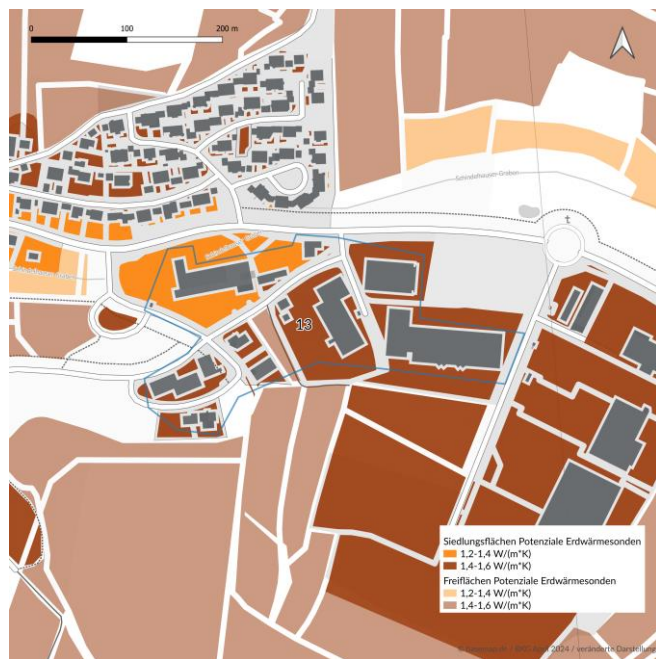
Nutzung von oberflächennaher Geothermie durch Erdwärmesonden
