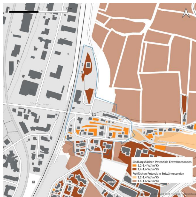
Nutzung von oberflächennaher Geothermie durch Erdwärmesonden
