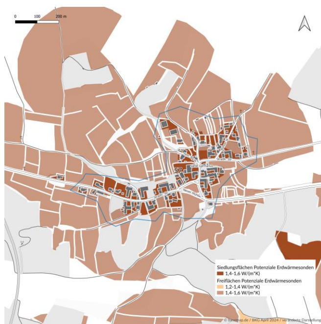
Nutzung von oberflächennaher Geothermie durch Erdwärmesonden
