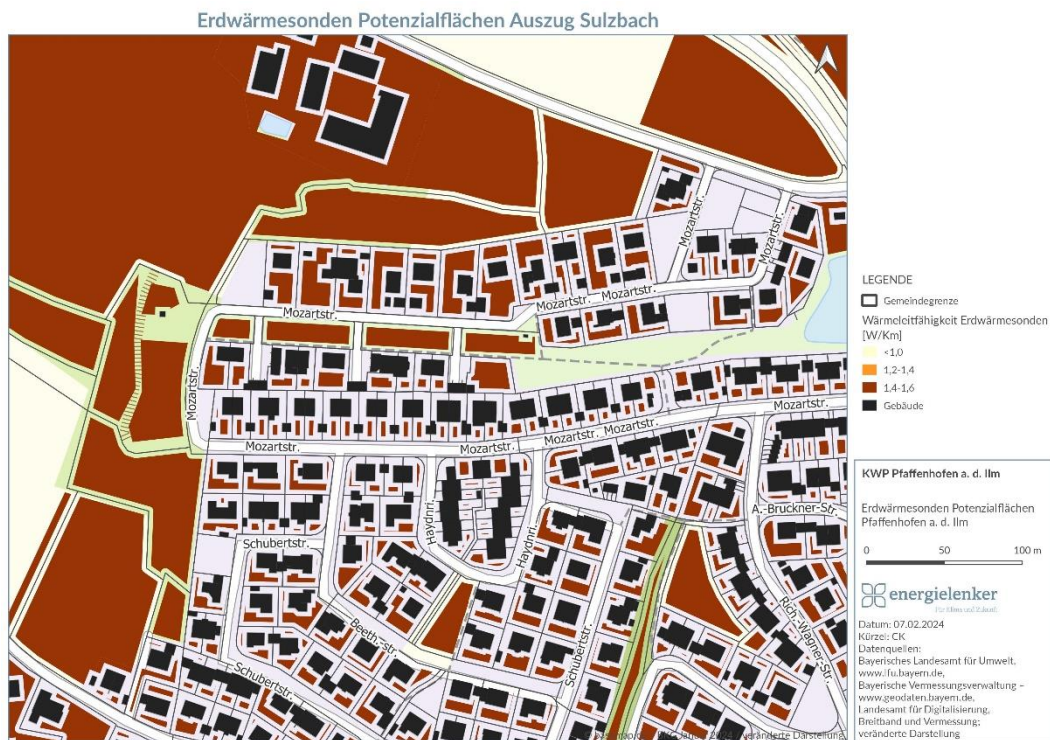
Abbildung 3-9: Ausschnitt der Potenzialflächen für Erdwärmesonden am Beispiel Sulzbach
