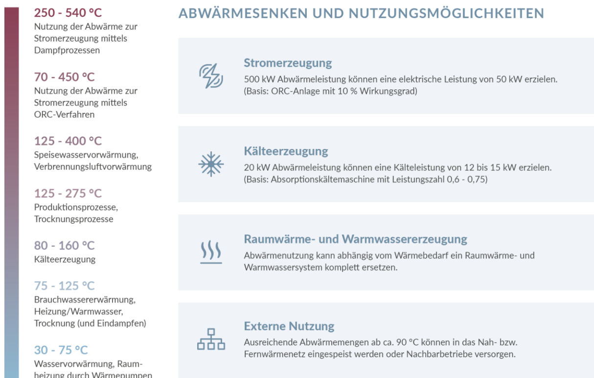
Abbildung 3-4: Nutzung von industrieller und gewerblicher Abwärme in Abhängigkeit des Temperaturniveaus
